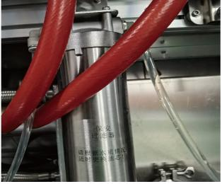
内置多级过滤器,可有效拦截各种颗粒有机物、腐 蚀性氯粒子保护系统安全。
