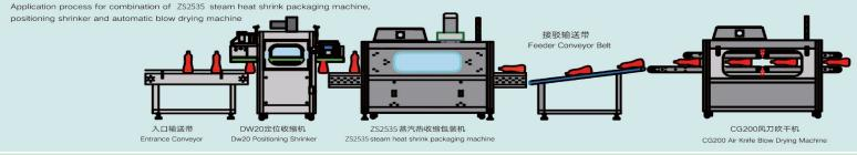
ZS2535蒸汽热收缩包装机与DW20定位收缩机、CG200风刀吹干机组线使用,可以对需要包底的产品进行底部长度自动定位并预先收缩,然后流入 ZS2535蒸汽热收缩机进行整体收缩,后面流入自动吹干机对表面水汽自动吹干,节约人工定位、吹干工序,提高生产效率,降低生产成本。
