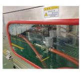
双层嵌套式钢化玻璃收缩炉道、数字刻度气流调节阀门、手 摇自锁升降系统、在线可视化系统设计,可以不停机的状态下可 视化调节运行参数。
