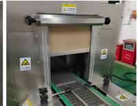
进出口配置升降式卷闸 帘,精确控制进出口气流, 配合电脑参数灵活调节。
