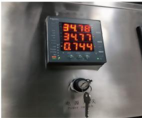
配备国际一线品牌高端电力仪表、总电源钥匙控制系统、前后安全急
