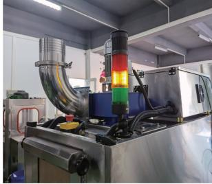
数控排气调节系统,精确控制炉道内蒸汽存量 ,改善收缩效果;
