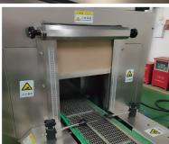
进出口配置升降式卷闸 帘,精确控制进出口气流, 配合电脑参数灵活调节。
